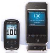
Der neue BG\*Star (linkes Gerät) arbeitet mit dynamischer Elektrochemie, die, so Frau Bergdolt, verlässliche Messergebnisse liefert, da bei der Berechnung des Blutzuckerwertes der individuelle Hämotokrit-Wert (statt eines gemittelten Wertes) herangezogen werde.
